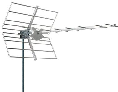
Antenna Yagi di **banda UHF** con connettore F e **doppio filtraggio**, che combina la selezione delle frequenze 5G e 4G LTE data dalla **geometria degli elementi** al **filtro 5G integrato** nel dipolo radiatore. **Riflettori a cortina** (tubicino).
